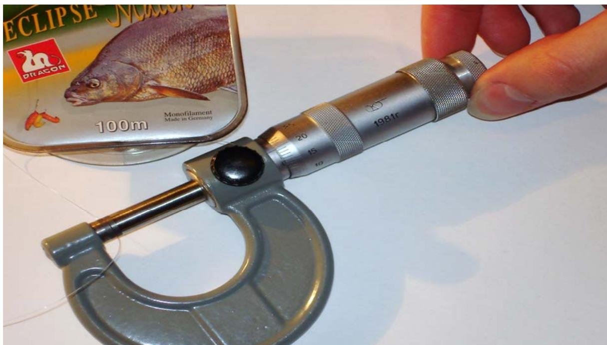
Показания микрометра должны соответствовать диаметру лески, указанному на упаковке. Для любительской лески допускается отклонение не более чем на одну сотую миллиметра, а для более качественных - пять тысячных миллиметра. Если отклонения выше, то к таким лескам необходимо относиться уже с осторожностью.
